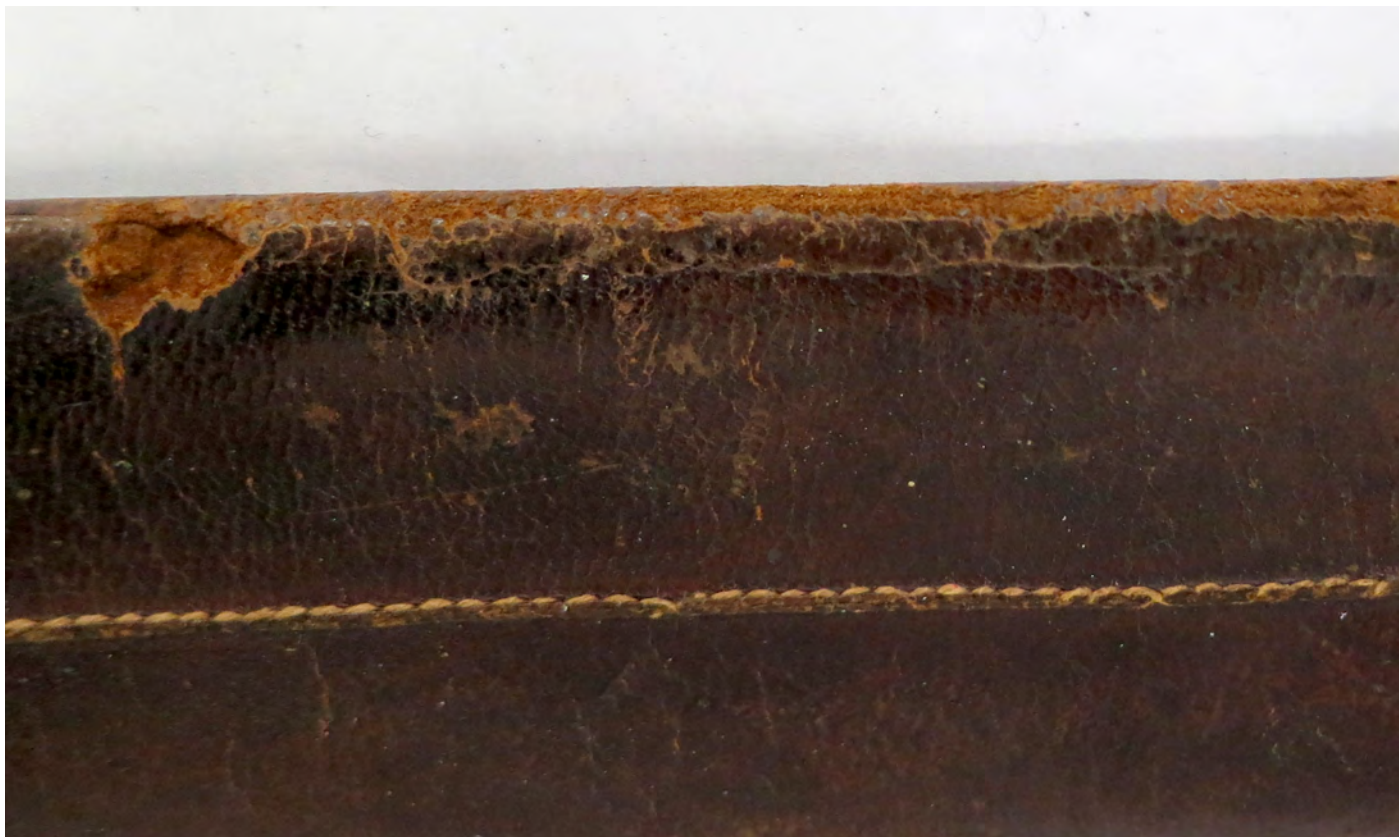
Pitzadurak, ertzetako higadura, zarrastaden ondoriozko material-galera, arrailak
